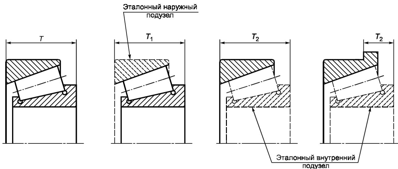
$T$  — номинальная ширина (монтажная высота) роликового конического подшипника;  $T_1$  — номинальная монтажная высота внутреннего подузла роликового конического подшипника;  $T_2$  — номинальная монтажная высота наружного кольца роликового конического подшипника
