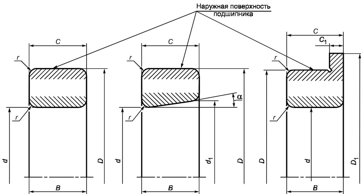
$d$  — номинальный диаметр отверстия;  $D$  — номинальный наружный диаметр;  $D_1$  — номинальный диаметр упорного борта наружного кольца;  $d_1$  — номинальный диаметр теоретического большого конического отверстия;  $B$  — номинальная ширина внутреннего кольца;  $C$  — номинальная ширина наружного кольца;  $C_1$  — номинальная ширина упорного борта наружного кольца;  $\alpha$  — угол конусности (половина угла конуса) отверстия внутреннего кольца;  $r$  — номинальный размер фаски
