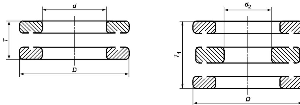
$d$  — диаметр отверстия тугого кольца одинарного подшипника;  $d_2$  — диаметр отверстия тугого кольца двойного подшипника;  $D$  — наружный диаметр свободного кольца;  $T$  — высота одинарного подшипника;  $T_1$  — высота двойного подшипника
