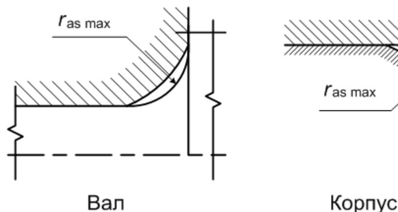
$r_{as \max}$  – наибольший радиус галтели вала или корпуса
